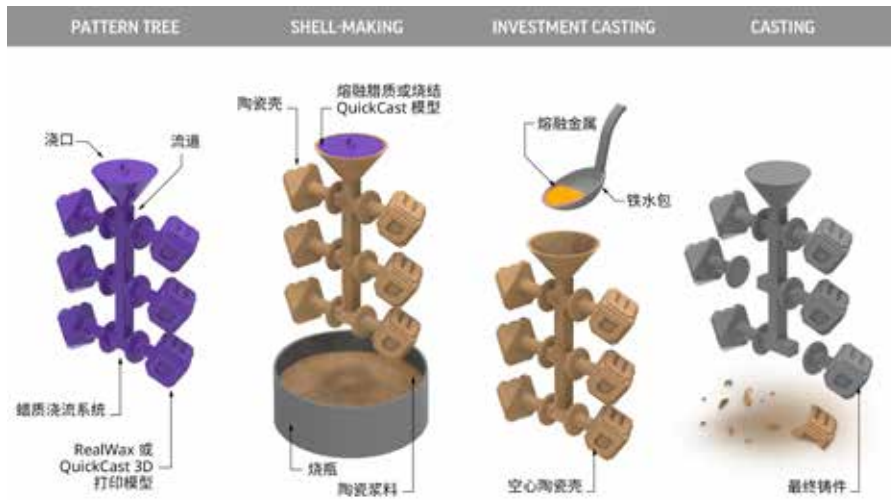
3D 打印模型烧结到失蜡或失壳熔模铸造工序中
